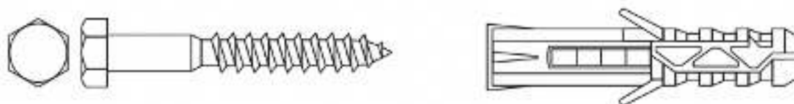
Рисунок 7.4.1 Шуруп с шестигранной головкой «Глухарь» с дюбелем
