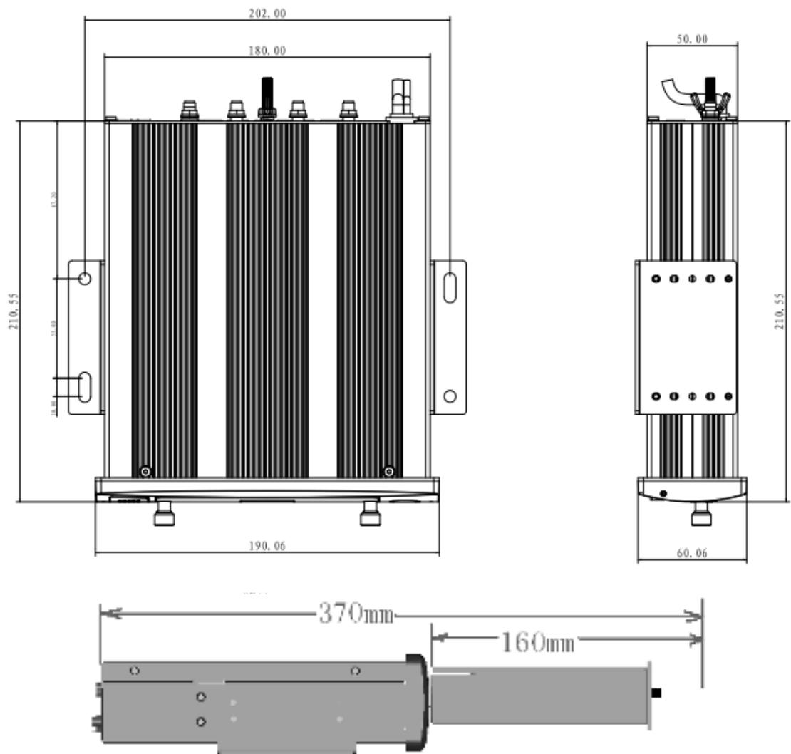
При установке MDVR на комплектные крепления и необходимости изоляции корпуса регистратора от платформы установки используйте резиновые прокладки.
