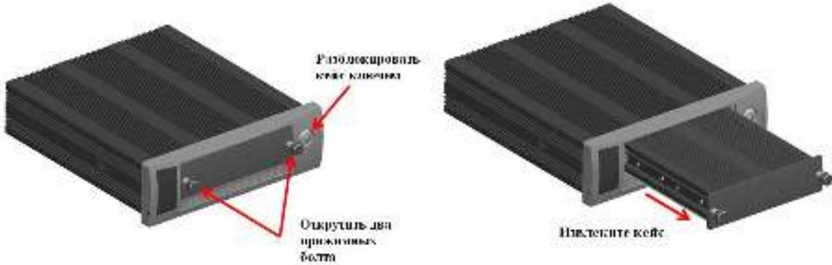
Разберите Mobile rack, как показано на рисунке ниже, и установите HDD. **SD-карта устанавливается в слот на задней панели MDVR.**
