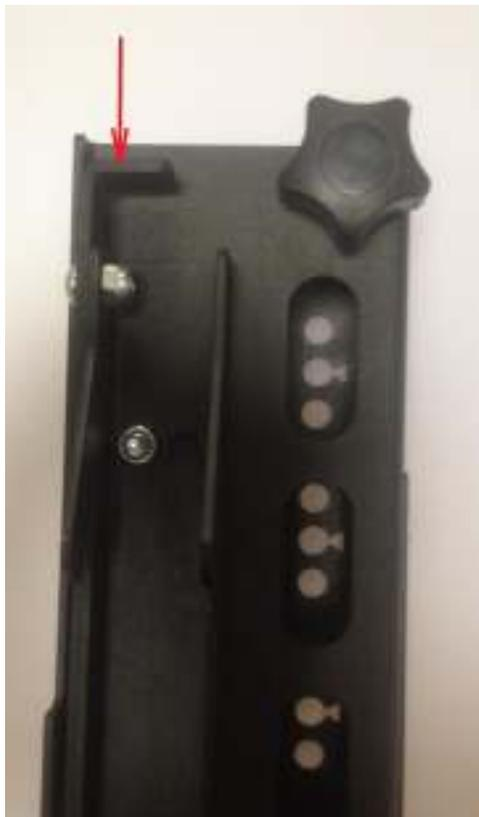
Рис.8 Фиксация стопорной планки. Левый кронштейн крепления.
