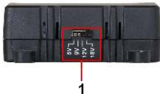
Рис. 3 Переключатель выбора выходного напряжения PoE Splitter/G2, вид сбоку
