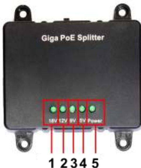
Рис. 4 LED индикаторы PoE Splitter/G2, вид сверху
